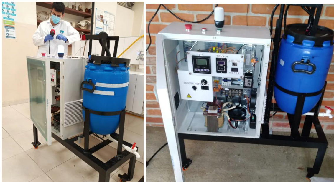
Figura 19. Equipo de electrólisis de salmuera de la Universidad de América, Bogotá.
