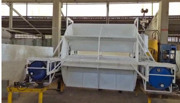
Figura 15. Turbina Colturbinas, a) vista isométrica. b) turbina en operación c). fotografía del prototipo y sus flotadores.
