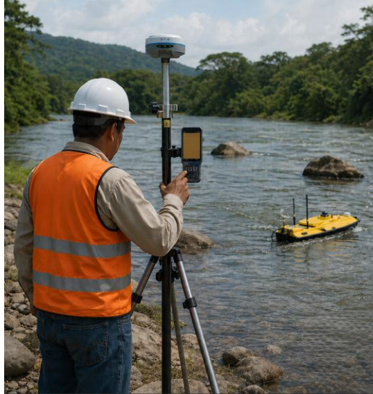
Figura 28. Medición de parámetros topográficos y batimétricos con equipos de posicionamiento GSP y bote hidrográfico autónomo (drone batimétrico); imagen generada con IA.
