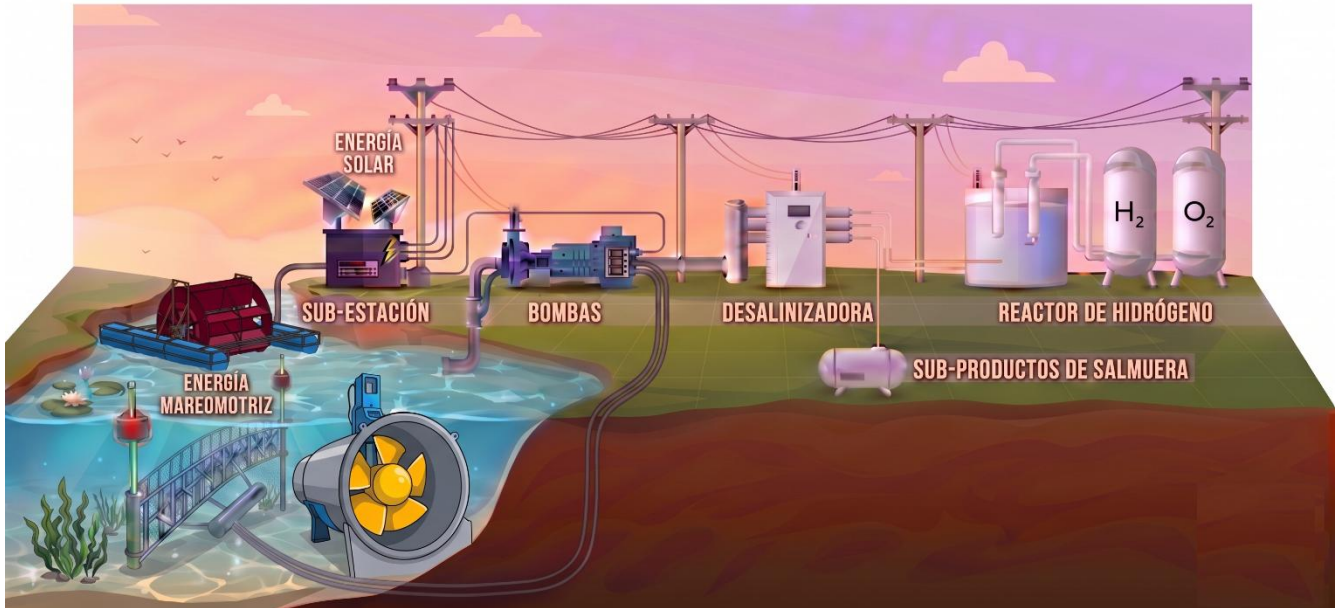
Figura 1. Esquema de una planta de producción de Hidrógeno Verde Mareomotriz (HVM) diseñada por los autores de la presente propuesta.
