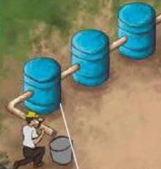
**2** El agua comienza su proceso de tratamiento mediante un filtro de grava que separa las impurezas mediante sedimentación.
